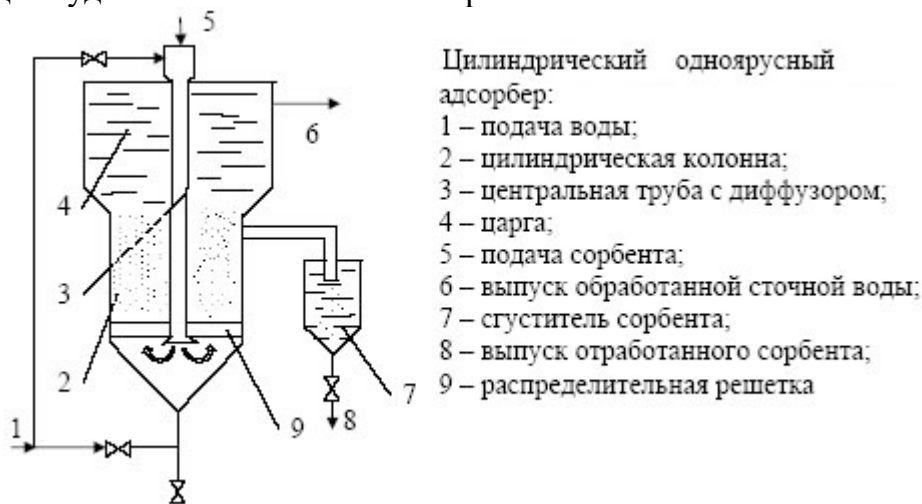
Рисунок 6.5.1. Цилиндрический одноярусный адсорбер
