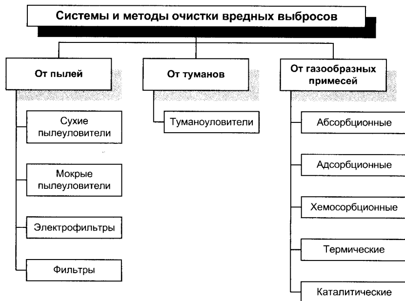
Рис. 6.1. Системы и методы очистки вредных выбросов
