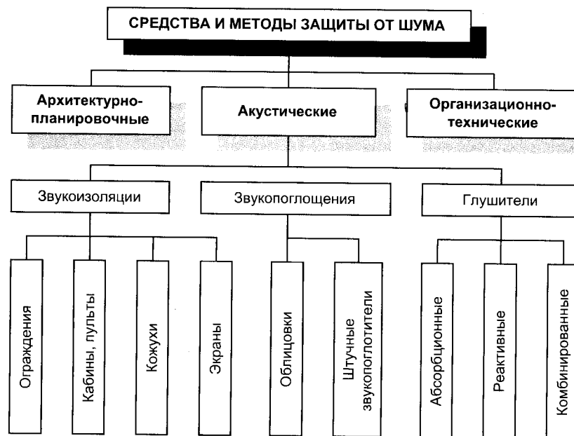
Рис. 10.2. Средства коллективной защиты от шума на пути его распространения
