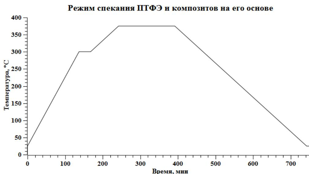
Рисунок 2. Режим спекания ПТФЭ и ПКМ на его основе
