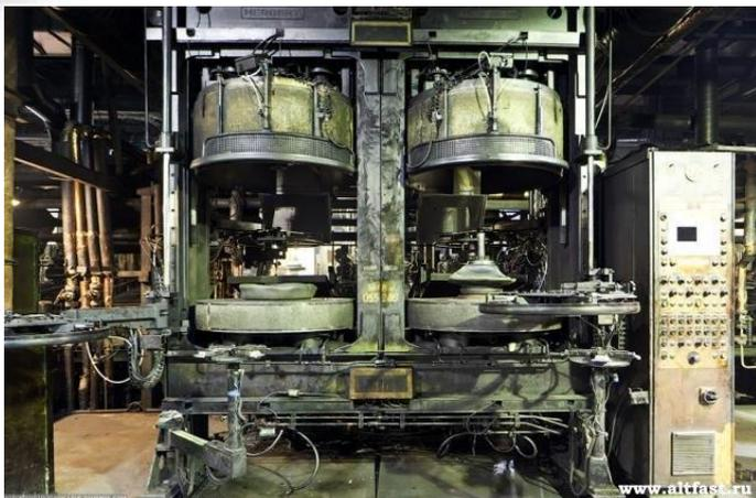
Форматор – вулканизатор для покрышек
