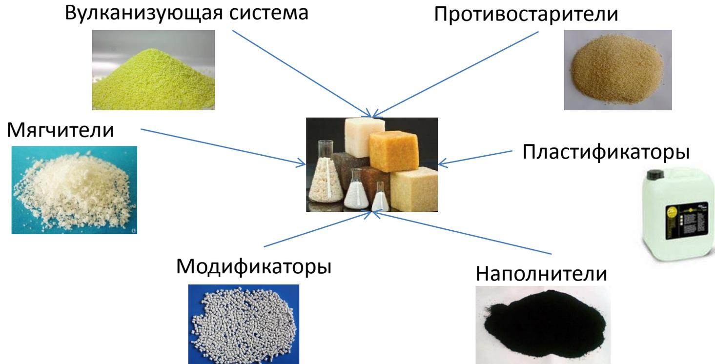
**Резина** - многокомпонентная система, состоящая из полимерной основы и целевых добавок: вулканизирующих систем, наполнителей, мягчителей, противостарителей, модификаторов и др.
