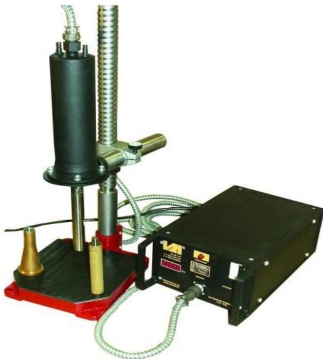
Общий вид лабораторной ультразвуковой установки ИЛ-100
