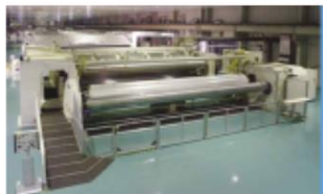
Рис. 4 Установка, на которой получают ориентированные пленки
