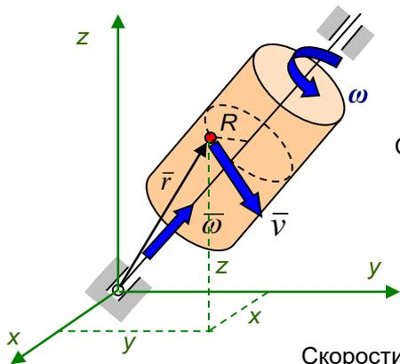
$$\vec{v} = \vec{\omega} \times \vec{r} = \begin{vmatrix} \vec{i} & \vec{j} & \vec{k} \\ \omega_x & \omega_y & \omega_z \\ x & y & z \end{vmatrix} = (\omega_y z - \omega_z y)\vec{i} + (\omega_z x - \omega_x z)\vec{j} + (\omega_x y - \omega_y x)\vec{k}$$
