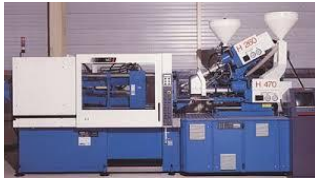
Рис. Схема изготовления изделий из термопластов литьем под давлением
