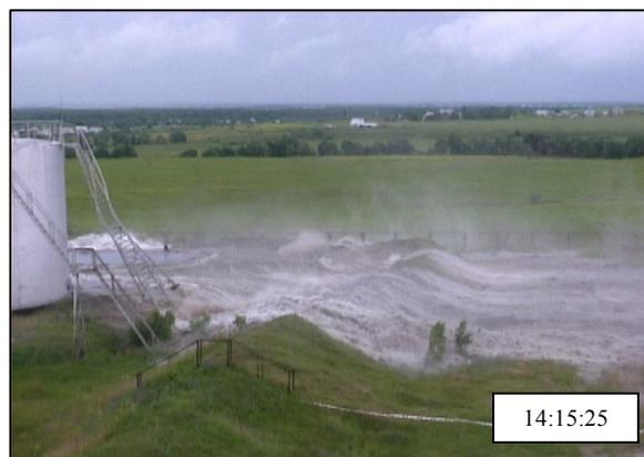
Рис. 3.3. Кадры видеосъемки полного разрушения РВС-700 с водой
