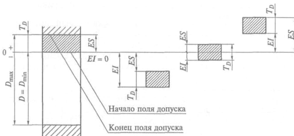
**Рис. 9.** Схема расположения полей допусков отверстий
