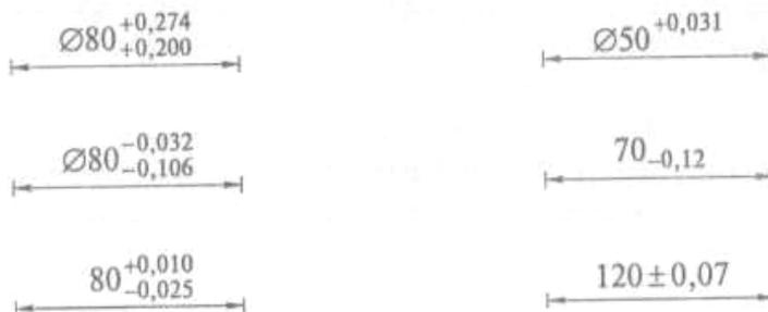
в) условными обозначениями полей допусков с указанием в скобках числовых значений соответствующих предельных отклонений [19]:
