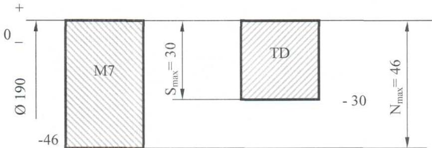
**Рис. 59.** Схема полей допусков сопряжения «наружное кольцо – отверстие в корпусе»
