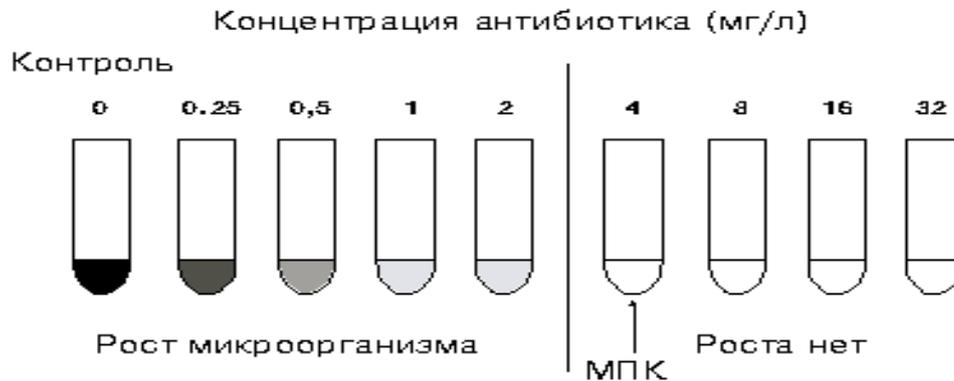
**Рисунок 3.** Определение значения МПК методом разведения в жидкой питательной среде.
