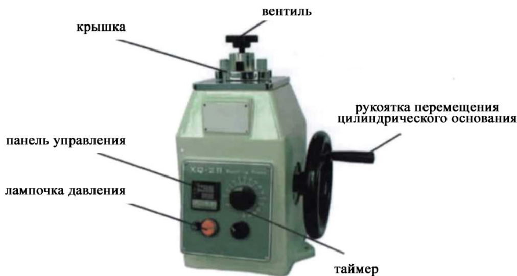
Рисунок 3. Пресс для горячей запрессовки образцов ХQ-2В
