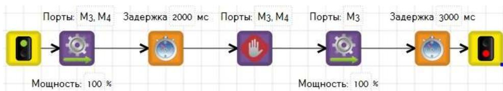
Попробуем совершить плавный поворот. Потребуется еще один блок «моторы вперед». В нем мы уберем порт M3 и изменим мощность на 50%. Получилось следующее:
