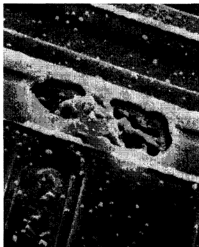
Рис. 3.76. Сканирующая электронная микрофотография высокого разрешения (x 1200) 6-амперного МОП-транзистора, разрушенного зарядом в 1 кВ, от «эквивалента человеческого тела» (1,5 кОм, включенного последовательно с емкостью 100 пФ), приложенного к его затвору. (С разрешения фирмы Motorola, Inc.)
