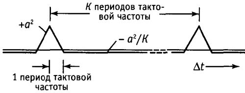
Рис. 9.87. Непрерывная автокорреляционная функция для полного цикла максимальной последовательности.
