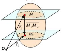
Теорема о плоскопараллельном движении твердого тела – плоскопаралллельное движение твердого тела однозначным образом определяется движением плоской фигуры, образованной сечением тела одной из параллельных плоскостей.
