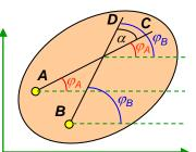
Углы наклона отрезков к горизонтальной оси различны и связаны между собой соотношением:  $\varphi_{R}(t) = \varphi_{A}(t) + \alpha$ .
