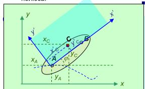
Таким образом, плоскопараллельное движение состоит из двух движений: поступательное и вращательное, и его всегда можно разложить на эти два движения.
